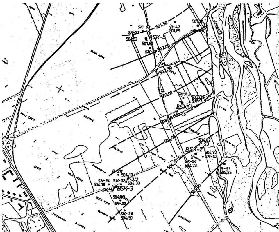
Slika 84. Potencijalne linije na izvišću Sokolović kolonija za dan 02.06.1997. godine, Q_{Z.V.S. ILIDŽA} = 7,2 \text{ m}^3/\text{s}
